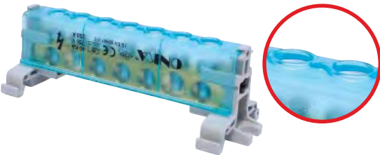
Kablo kesiti max. 50 mm 2 (Yüksüklü) - 70 mm 2 (Yüksüksüz)
